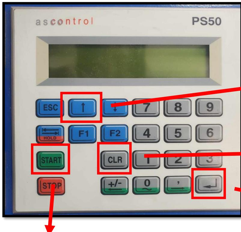
4. Ya que se presionó ENTER se tiene que presionar el botón START el cual mandara la señal para mover la máquina.
